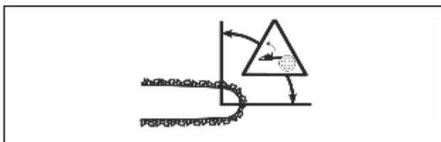
Un piccolo raggio sulla punta della barra diminuisce la forza del contraccolpo.
