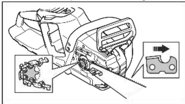
6. Montare il coperchio del pignone guida e inserire il fermo tendicatena nel foro sulla barra di guida.
