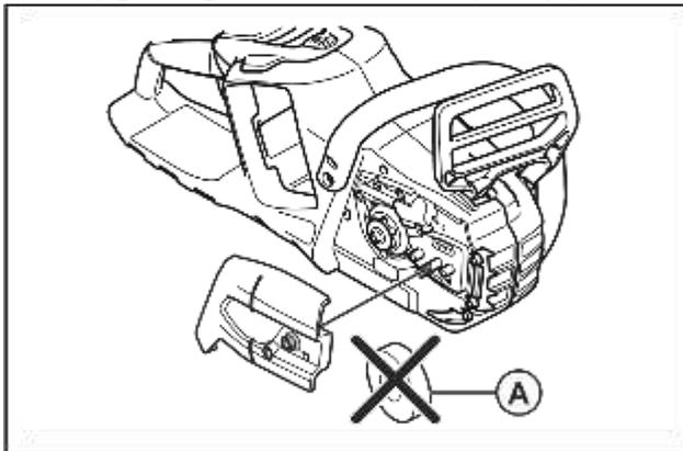
3. Posizionare la barra di guida sopra il bullone della barra. Portare la barra di guida nella sua posizione più arretrata. Sollevare la catena sopra il pignone guida e inserirla nella scanalatura sulla barra di guida. Cominciare dalla parte superiore della barra di guida.
