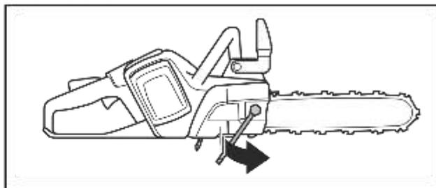
2. Sollevare la parte anteriore della barra di guida e girare la vite tendicatena. Servirsi della chiave universale.
