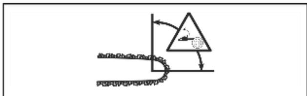
Il contraccolpo avviene sempre lungo il piano di taglio della barra di guida. In genere, il prodotto viene lanciato contro l'operatore, ma può anche spostarsi in un'altra direzione. Il modo in cui si utilizza il prodotto,
