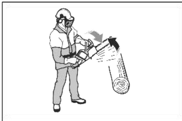
Utilizzare il freno della catena come freno di stazionamento quando si avvia il prodotto e quando ci si sposta per brevi distanze. Ciò diminuisce il rischio che l'operatore o una persona vicina tocchi la catena.
