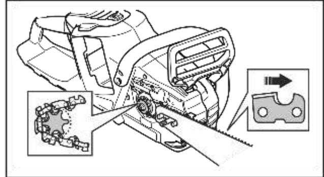
5. Montare il coperchio del pignone guida e inserire il fermo tendicatena nel foro sulla barra di guida.
