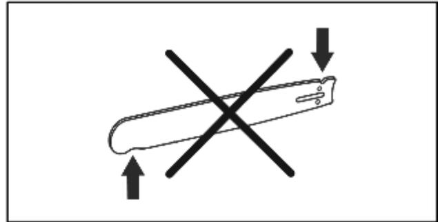
6. Controllare che il rocchetto puntale ruoti liberamente e che il relativo foro di lubrificazione non sia ostruito. Pulire e lubrificare se necessario.
