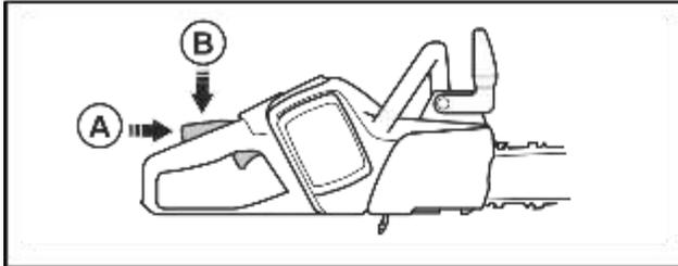
3. Assicurarsi che la leva di comando sia bloccata sul minimo quando viene rilasciato il fermo della leva di comando.
