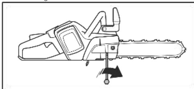
4. Serrare il dado della barra con la chiave e sollevare contemporaneamente la parte anteriore della barra di guida.
