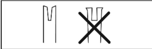
5. Verificare se la punta della barra di guida è irregolare o molto usurata.
