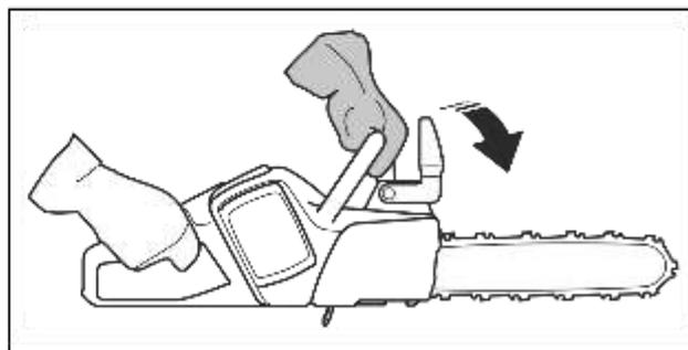
In posizione di abbattimento non è possibile innestare manualmente il freno della catena. Il freno della catena può essere innestato in questa posizione solo tramite il meccanismo di attivazione inerziale.
