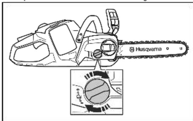
3. Serrare la manopola della barra e sollevare contemporaneamente la parte anteriore della barra di guida.
