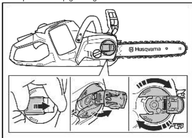
2. Sollevare la parte anteriore della barra di guida e girare il ruotino tendicatena. Serrare la catena fino a quando è serrata contro la barra di guida.
