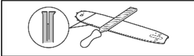
3. Pulire la scanalatura della barra di guida.
