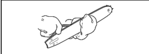
4. Verificare se la scanalatura della barra di guida presenta segni di usura. Sostituire la barra di guida se necessario.
