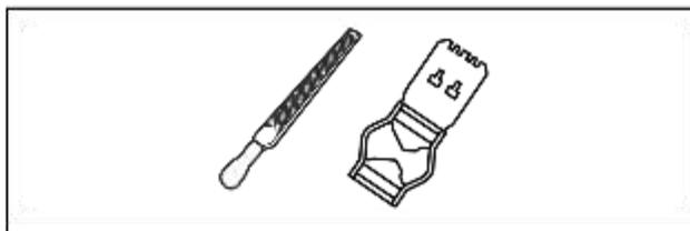
1. Utilizzare una lima piatta e uno strumento di misurazione dell'aggetto di spoglia per questa impostazione. Si raccomanda l'utilizzo del nostro strumento di misurazione dell'aggetto di spoglia Husqvarna per avere profondità e angolo corretti.
