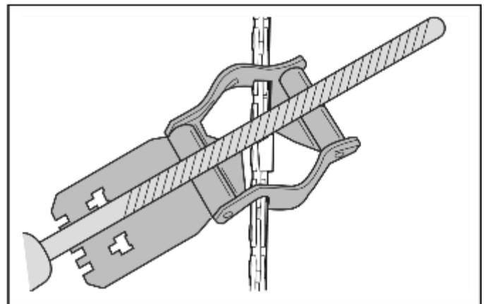
4. Entfernen Sie Material von der einen Seite aller Schneidezähne.
