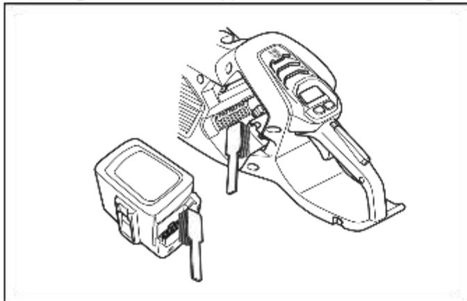
3. Stellen Sie sicher, dass der Akku nicht beschädigt oder verformt ist und dass keine sonstigen Schäden wie zum Beispiel Risse vorhanden sind.
