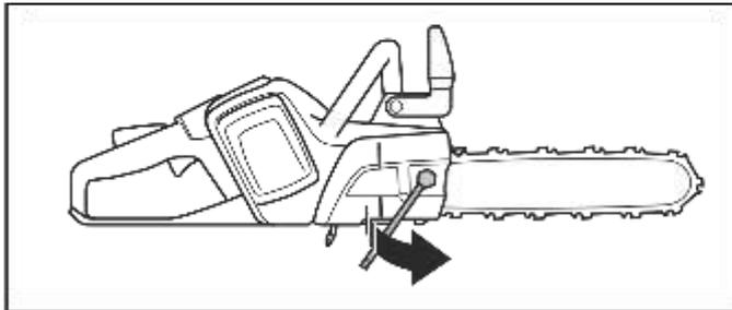
2. Heben Sie die Spitze der Führungsschiene an und drehen Sie die Kettenspannschraube. Verwenden Sie dazu den Kombischlüssel.
