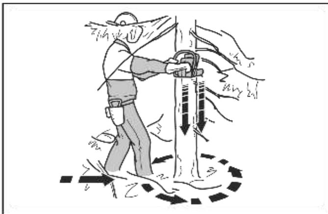
2. Entfernen Sie Unterholz aus dem Arbeitsbereich um den Baum. Entfernen Sie alle gesägten Teile aus dem Arbeitsbereich.
