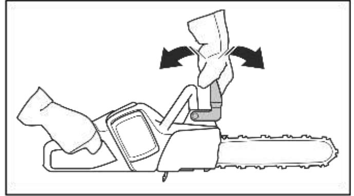
3. Halten Sie das Gerät mit abgeschaltetem Motor über einen Baumstumpf oder einen anderen stabilen Gegenstand.
