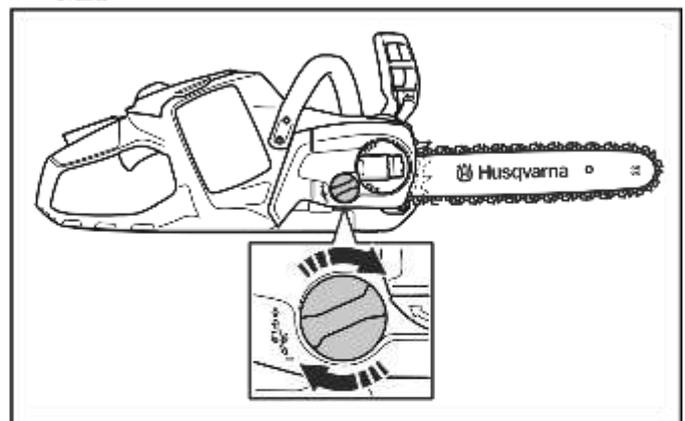
3. Ziehen Sie die Spannmutter an und heben Sie gleichzeitig die Spitze der Führungsschiene an.
