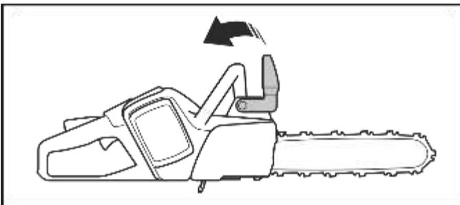
2. Lösen Sie die Spannmutter.
