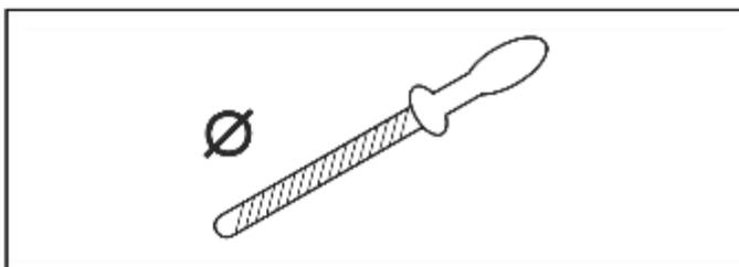
Ohne Hilfsmittel ist es nicht leicht, eine Sägekette korrekt zu schärfen. Verwenden Sie Husqvarna Schärfflehre. Dies hilft Ihnen, die maximale Schnittleistung zu erhalten und die Rückschlaggefahr auf ein Minimum zu reduzieren.
