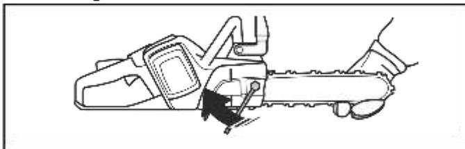
5. Stellen Sie sicher, dass sich die Sägekette leicht von Hand bewegen lässt, aber nicht von der Führungsschiene herab hängt.
