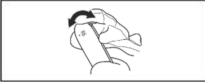
4. Tauschen Sie die Sägekette aus, wenn der längste Teil des Schneidezahns weniger als 4 mm lang ist. Tauschen Sie die Sägekette auch bei Rissen am Schneidwerkzeug aus.
