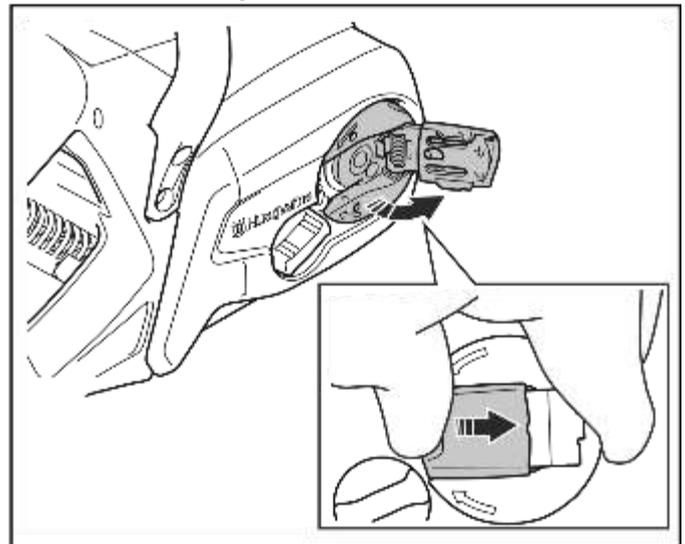
1 Entfernen Sie die Abdeckung des Kettenantriebsrads und den Transportring (A).
