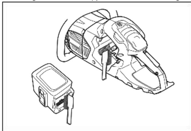
3. Stellen Sie sicher, dass der Akku nicht beschädigt oder verformt ist und dass keine sonstigen Schäden wie zum Beispiel Risse vorhanden sind.
