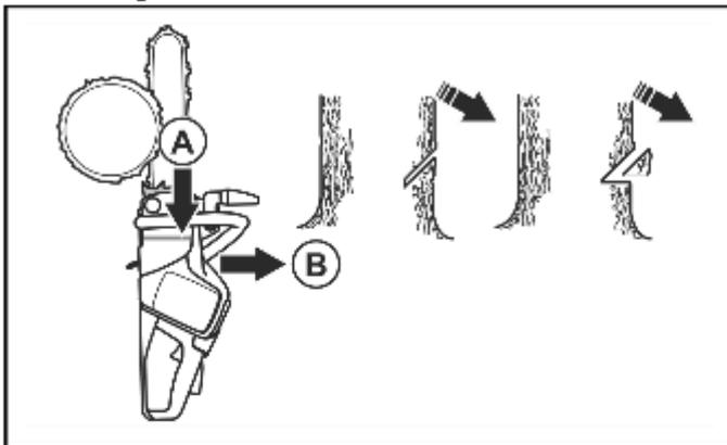
2. Stellen Sie sicher, dass die Kerbschnittlinie genau waagrecht ist und im rechten Winkel (90 °) zur Fallrichtung steht. Die Kerbschnittlinie geht durch den Punkt, wo die beiden Kerbschnitte sich berühren.
