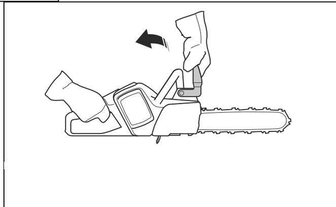
Die Art und Weise, wie die Kettenbremse aktiviert wird, hängt von der Kraft des Rückschlags und der Position des Geräts ab. Bei einem heftigen Rückschlag und wenn sich der Rückschlagbereich so weit wie möglich von Ihnen entfernt befindet, wird die Kettenbremse durch die Trägheitsfunktion aktiviert. Bei einem leichten Rückschlag oder bei einem Rückschlag in Ihrer Nähe wird die Kettenbremse manuell von Ihrer linken Hand aktiviert.
