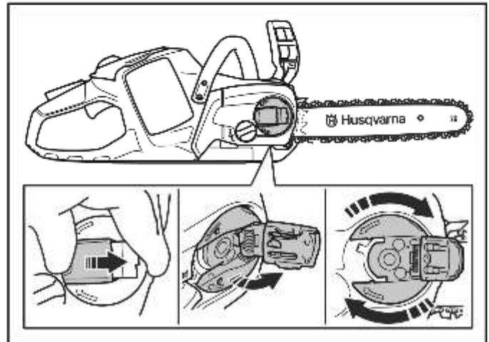
2. Heben Sie die Spitze der Führungsschiene an und drehen Sie die Kettenspannrolle. Ziehen Sie die Sägekette fest, bis sie fest an der Führungsschiene sitzt.
