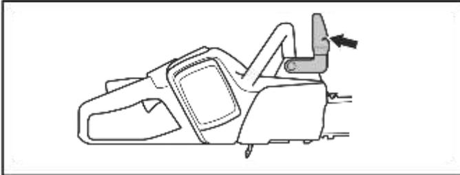
2. Stellen Sie sicher, dass der Handschutz sich frei bewegen lässt und sicher am Gerät befestigt ist.
