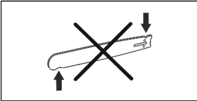
7. Drehen Sie die Führungsschiene täglich zur Verlängerung der Lebensdauer.
