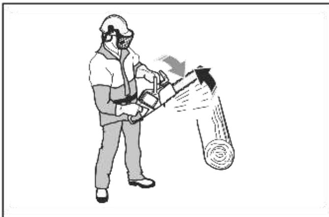
Verwenden Sie die Kettenbremse als Feststellbremse, wenn Sie das Gerät starten und sich über kurze Strecken bewegen. Dadurch reduzieren Sie das Risiko, dass Sie selbst oder Umstehende von der Sägekette erfasst werden.
