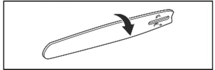
6. Kontrollieren Sie, ob der Umlenkstern der Führungsschiene sich leicht bewegen lässt und sein Schmierloch offen ist. Reinigen und schmieren Sie ihn bei Bedarf.
