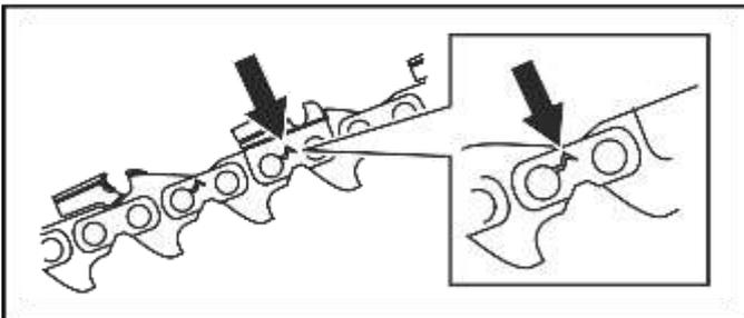
4. Überprüfen Sie die Nut in der Führungsschiene auf Verschleiß. Tauschen Sie die Führungsschiene aus wenn nötig.
