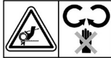
Bei laufendem Motor niemals Umlenkrollen oder Riemen berühren und keine Wartungsarbeiten durchführen; Hände fernhalten.
