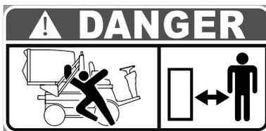
Der Grasfangkorb kann angehoben und gekippt werden; bei laufender Maschine den angemessenen Abstand halten.
