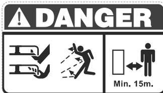
Hände oder Füße vom Mähwerk fernhalten wenn der Motor läuft. Auf keinen Fall auf Schotter arbeiten oder Fremdkörper könnten angesaugt und von den Messern weggeschleudert werden, was recht gefährlich ist. Personen mindestens 15 Meter von der Maschine fernhalten, wenn diese läuft.
