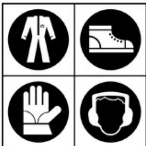
Vor der Benutzung der Maschine muss obligatorisch die dafür vorgesehene Sicherheitskleidung angezogen werden: Körperschutzkleidung, Schutzhandschuhe, Sicherheitsschuhe, Gehörschutz.
