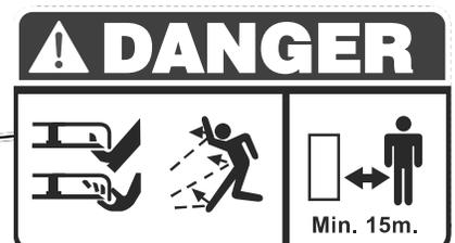
Gefahr durch scharfe Messer und Schleudergefahr durch drehende Messer
