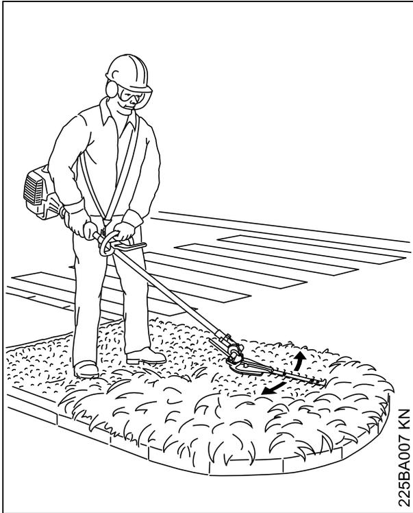
Arbeitshaltung und Arbeitsweise wie bei einer Motorsense: Schneidmesser bogenförmig am Boden entlangführen.
