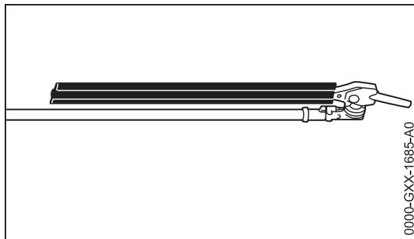
Per trasportare l'apparecchiatura risparmiando spazio, è possibile sistemare parallelamente allo stelo la barra falciante, bloccandola in questa posizione.
