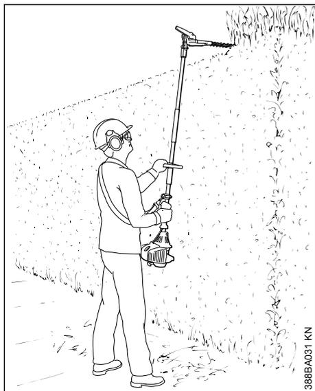
Tenere e muovere il tosasiepi verticalmente, in modo da creare un ampio raggio di azione.
