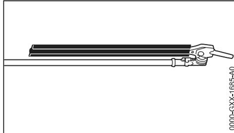
Zum platzsparenden Transport des Gerätes kann der Messerbalken parallel zum Schaft geschwenkt und in dieser Position festgesetzt werden.
