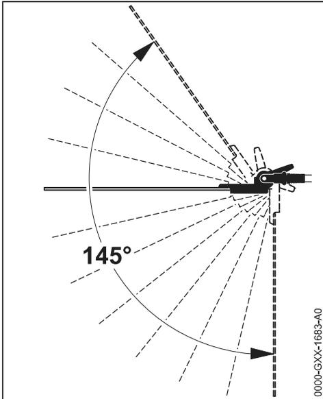
Der Winkel des Messerbalkens kann zum Schaft zwischen 0° (völlig gestreckt) bis 55° (in 4 Stufen nach oben) sowie in 7 Stufen bis 90° (rechter Winkel nach unten) verstellt werden. Es sind 12 einzeln einstellbare Arbeitslagen möglich.
