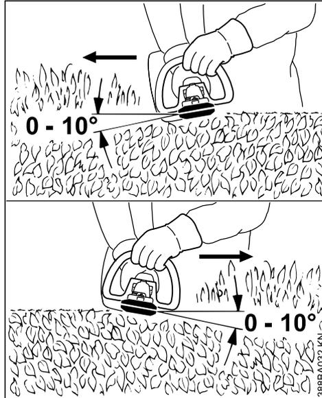
Schneidmesser in einem Winkel von 0° bis 10° ansetzen – aber waagrecht führen.
