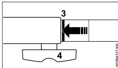
Richtig eingeschoben muss die rote Linie (3 = Pfeilspitze) mit der Kupplungsmuffe bündig sein.
