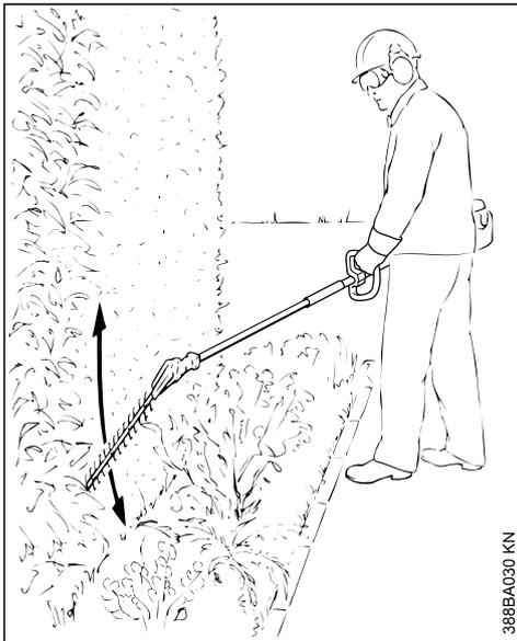
Schneiden ohne direkt an der Hecke zu stehen – z. B. bei dazwischenliegenden Blumenbeeten.
