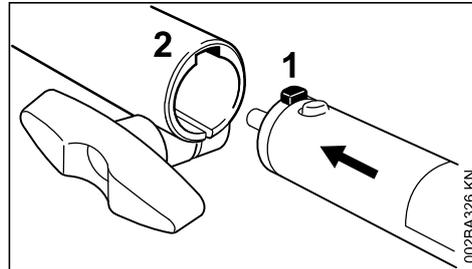
► Zapfen (1) am Schaft bis zum Anschlag in die Nut (2) in der Kupplungsmuffe schieben
