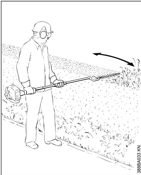
Heckenschneider sichelförmig zum Rand bewegen, damit die abgeschnittenen Zweige zu Boden fallen.
