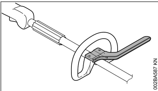
Der Bügel (Schrittbegrenzer) befindet sich im Lieferumfang des Gerätes und soll am Rundumgriff angebaut werden.
