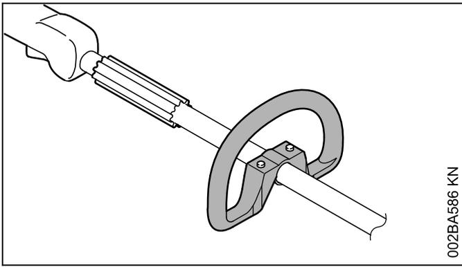
Im Lieferzustand des neuen Gerätes ist der Rundumgriff am Gerät bereits angebaut.
