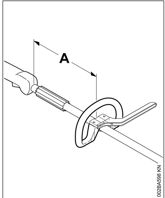
Durch Ändern des Abstands (A) kann der Griff in die für die Bedienungsperson und den Anwendungsfall günstigste Lage gebracht werden.
