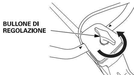
Dopo avere regolato la posizione dell'impugnatura o l'inclinazione del manubrio, accertarsi che il cavo acceleratore non sia troppo teso. Verificare inoltre che la leva di comando acceleratore funzioni correttamente.
