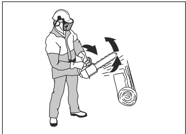
Un piccolo raggio sulla punta della barra diminuisce la forza del contraccolpo.
