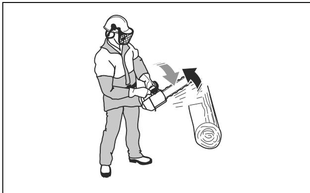
Utilizzare il freno della catena come freno di stazionamento quando si avvia il prodotto e quando ci si sposta per brevi distanze. Ciò diminuisce il rischio che l'operatore o una persona vicina tocchi la catena.
