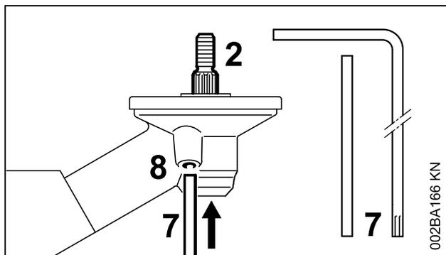
Pour le montage et le démontage des outils de coupe, il faut bloquer l'arbre (2) à l'aide du mandrin de calage (7) ou du tournevis coudé (7). Les pièces font partie du jeu de pièces joint à la livraison de la machine ou sont livrables à titre d'accessoire optionnel.
