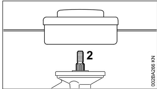
Il est seulement possible de monter des têtes faucheuses, à fixer directement sur l'arbre (2).
