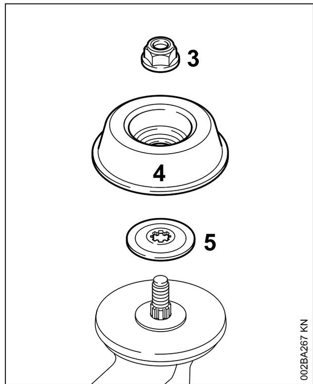
Pour la fixation de certaines têtes faucheuses et des couteaux à herbe, il faut utiliser en outre l'écrou (3), le bol glisseur (4) et le disque de pression (5).
