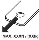
Die max. zulässige horizontale Kraft auf die Anhängerkupplung ist in *Technische Daten auf Seite 40* und auf dem Etikett angegeben.
