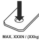
Die max. zulässige vertikale Kraft auf die Anhängerkupplung ist in *Technische Daten auf Seite 40* und auf dem Etikett angegeben.
