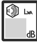
Etikett mit Geräuschemissionen gemäß EU- und UK-Richtlinien und Verordnungen sowie der australischen „Protection of the Environment Operations (Noise Control) Regulation 2017“ (Umweltschutz-/Lärmschutzbestimmung) von New South Wales. Der garantierte Schalleistungspegel des Geräts ist unter *Technische Daten auf Seite 40* und auf dem Etikett angegeben.
