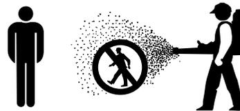
Blasrohr niemals in die Richtung anderer Personen halten – das Motorgerät kann kleine Gegenstände mit großer Geschwindigkeit hochschleudern – **Verletzungsgefahr!**
