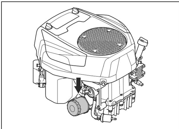
3. Lubrificare leggermente la guarnizione in gomma sul nuovo filtro dell'olio con olio motore nuovo.
