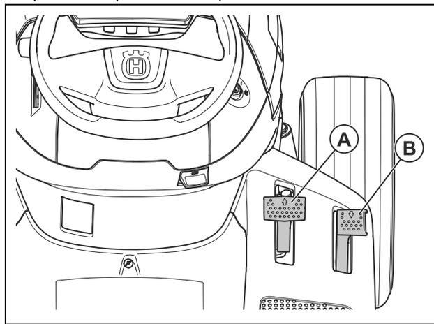
**Nota:** Il pedale di marcia avanti e il pedale di retromarcia tornano in posizione neutra quando vengono rilasciati.
