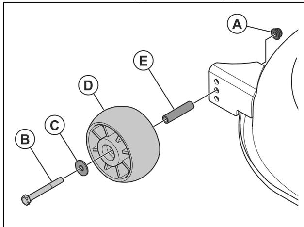
4. Installare la ruota antirasatura, la bussola, il bullone, la rondella e il dado in 1 dei 3 fori.
