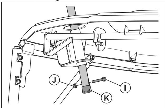
6. Installare la vite (I) e il dado (J) nel tubo dell'impugnatura del raccoglierba.
