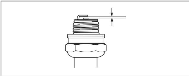
6. Piegare l'elettrodo laterale per regolare la distanza tra gli elettrodi.
