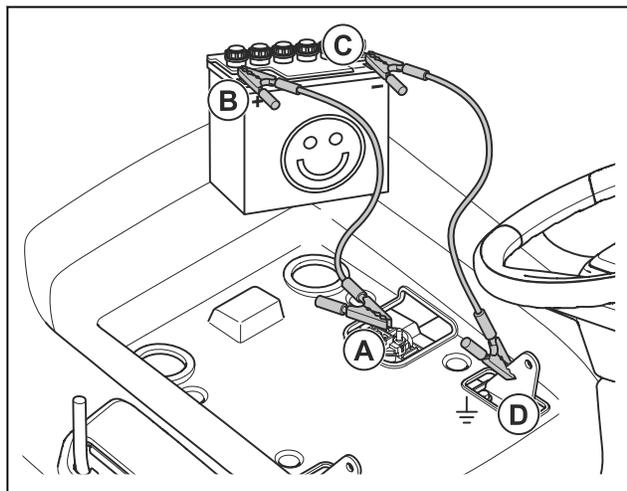
2. Collegare l'altra estremità del cavo rosso al morsetto POSITIVO (+) (B) della batteria alla batteria carica.
