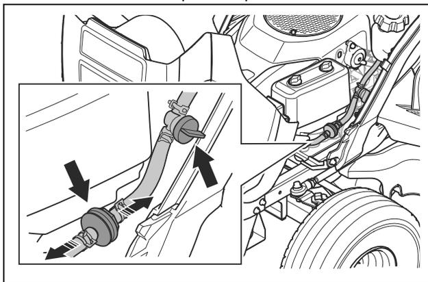
6. Spingere il nuovo filtro carburante nelle estremità del tubo. Applicare del detergente liquido sulle estremità del filtro del carburante per rendere più semplice il collegamento.
