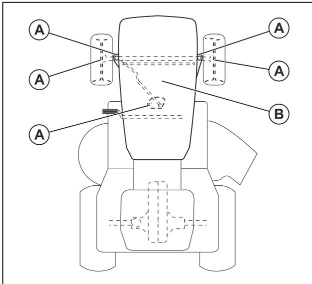
A. Lubrificazione generale. Lubrificare il collegamento di ingrassaggio dell'alberino e i denti dell'ingranaggio del settore e del piantone dello sterzo.
