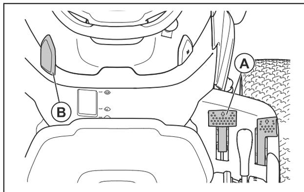
2. Tirare verso l'alto il blocco del regolatore di velocità (B) e mantenerlo in questa posizione mentre si rilascia il pedale di marcia avanti.
