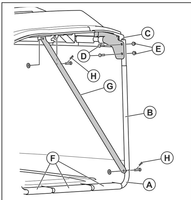
3. Fissare gli elementi del tubo di gomma (F) alla parte finale del telaio anteriore.
