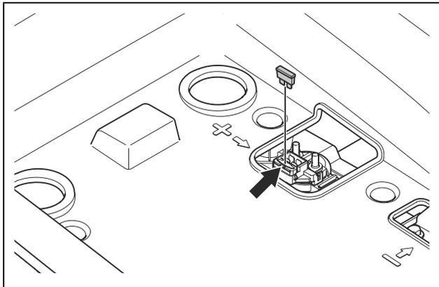
4. Sostituire il fusibile bruciato con un nuovo fusibile dello stesso tipo. Fare riferimento a *Dati tecnici alla pagina 174*.
