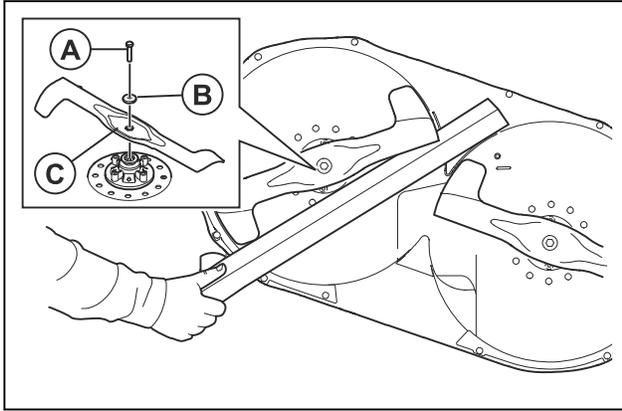
3. Entfernen Sie die Schraube (A), die Unterlegscheibe (B) sowie die Klinge (C).
