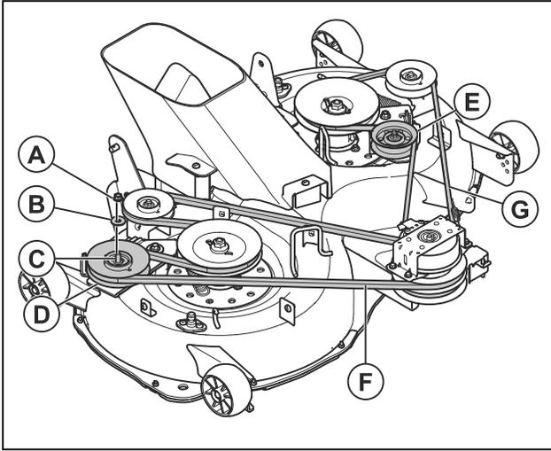
4. Entfernen Sie die Mutter, die Unterlegscheibe, die Schraube und die linke Riemenscheibe (E).
