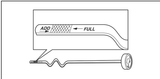
8. Füllen Sie Öl durch die Öffnung für den Ölmesstab ein. Füllen Sie das Öl langsam ein.
