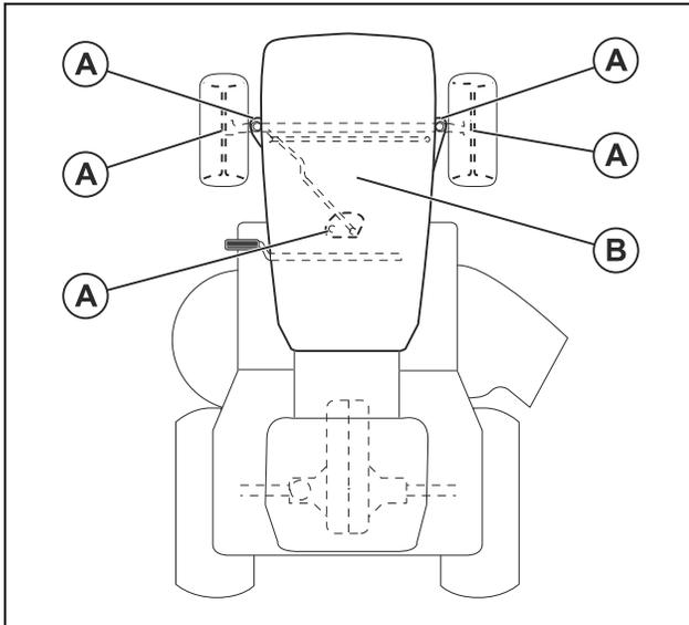
A. Allgemeine Schmierung. Schmieren Sie den Spindelschmieranschluss und die Zahnradzähne des Segmentzahnrad und der Lenksäule.
