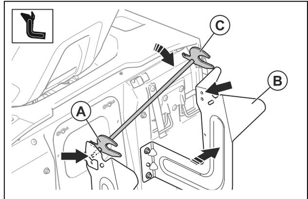
4. Drücken Sie die rechte Halterung (B) vorsichtig nach rechts. Setzen Sie die rechte Seite (C) der Stangenbaugruppe in die Bohrung in der rechten Halterung ein.
