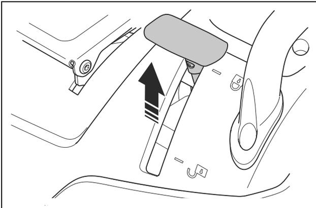
5. Um den Grasfänger zu entfernen, bringen Sie den Verriegelungshebel für den Grasfänger in die entriegelte Position. Heben Sie den Grasfänger aus der Halterung.
