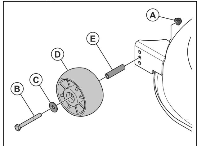
4. Montieren Sie die Schwimmrolle, die Buchse, die Schraube, die Unterlegscheibe und die Mutter in 1 der 3 Bohrungen.
