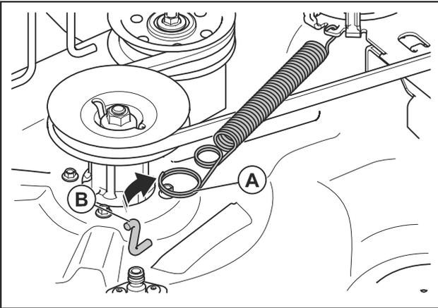
6. Entfernen Sie den Mähdeckriemen von der Motorriemenscheibe.
