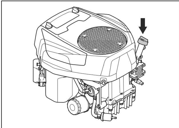
4. Reinigen Sie den Messstab von Öl.
