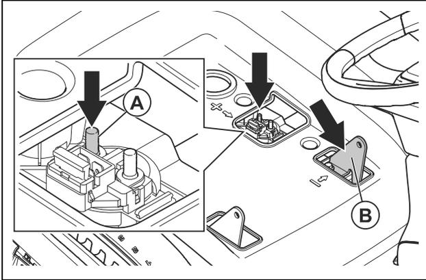
2. Schließen Sie das negative (-) Ladekabel an den negativen (-) Anschluss (B) an.
