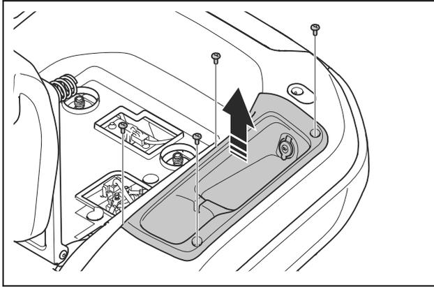
3. Entfernen Sie die Klemmenabdeckung am schwarzen Akkukabel.
