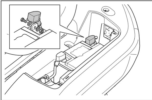
5. Entfernen Sie die Klemmenabdeckung am roten Akkukabel.
