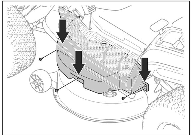
4. Entfernen Sie die 3 Schrauben und die rechte Riemenabdeckung.
