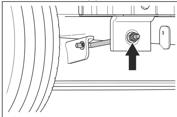
**Hinweis:** Das vordere Verbindungsglied befindet sich an der Vorderseite des Geräts, hinter dem Schalldämpfer.
