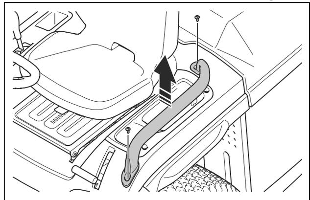
2. Montieren Sie den Handgriff in umgekehrter Reihenfolge.
