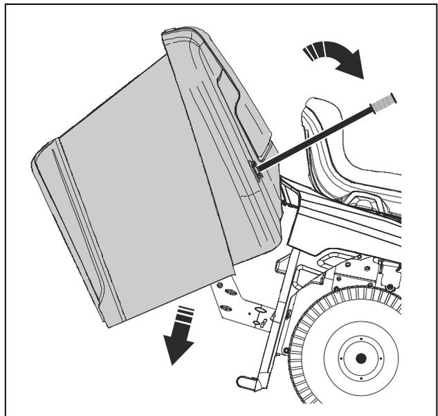
6. Drücken Sie den Griff des Grasfängers nach hinten, um den Grasfänger abzusenken. Stellen Sie sicher, dass der Grasfänger vollständig abgesenkt ist.
