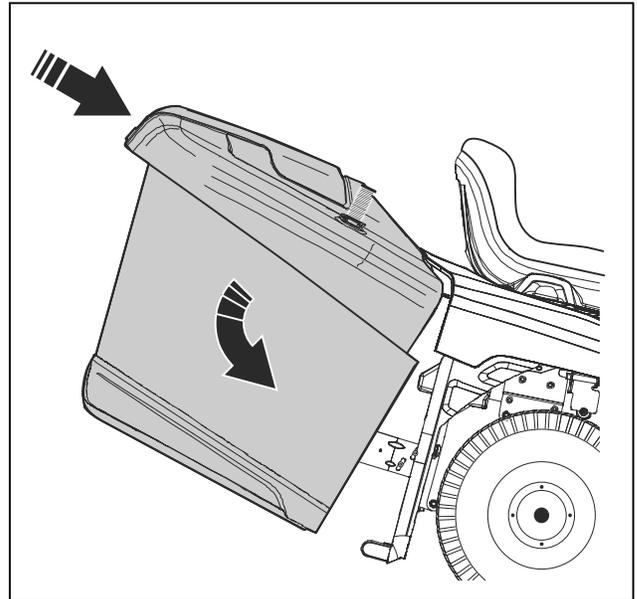
2. Stellen Sie sicher, dass sich der Verriegelungshebel für den Grasfänger in der entriegelten Position befindet.
