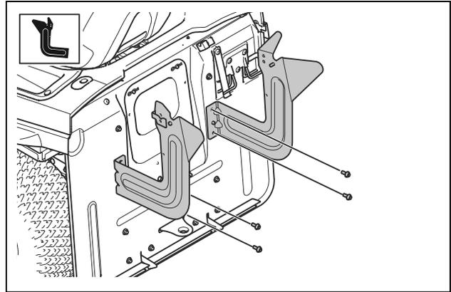
2. Installieren Sie die rechte Halterung mit den 2 Schrauben.
