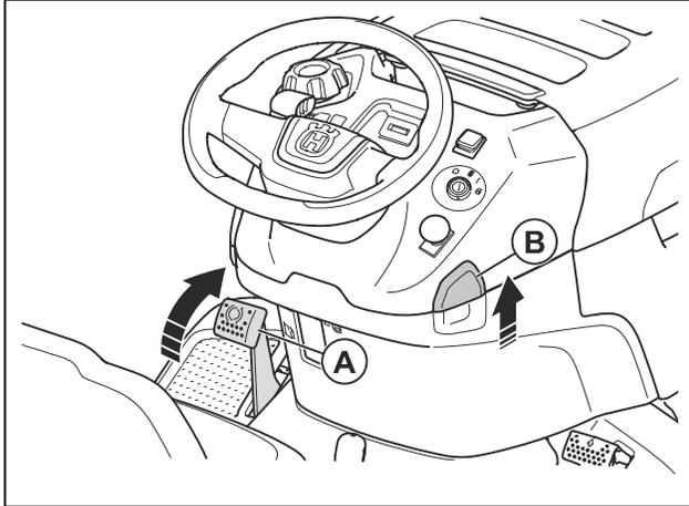
b) Lassen Sie das Feststellbremspedal los.
