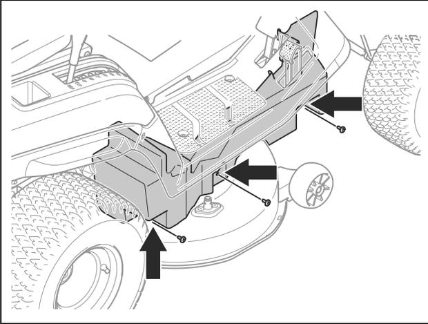
5. Entfernen Sie die 2 Federn (A) aus den 2 Federhalterungen (B), um die Spannung der 2 Mähdeckriemen zu verringern.
