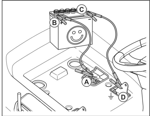
2. Schließen Sie das andere Ende des roten Akkukabels an die POSITIVE (+) Klemme (B) des geladenen Akkus an.
