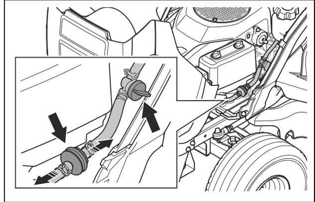
6. Schieben Sie den neuen Kraftstofffilter in die Schlauchenden. Verwenden Sie flüssiges Reinigungsmittel an den Enden des Kraftstofffilters, um ihn leichter auf den Schlauch schieben zu können.
