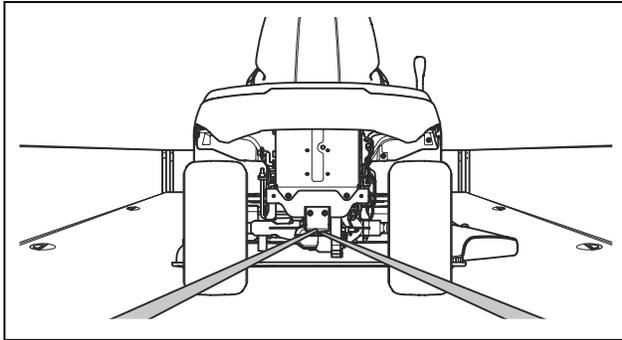
6. Ziehen Sie die Gurte nach hinten fest, um das Gerät auf dem Ladebereich zu befestigen.
