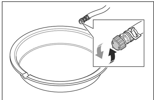
5. Wenn das gesamte Öl abgelassen ist, montieren Sie die Endkappe am Ölableitventil.
