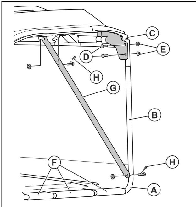
3. Befestigen Sie die Gummihüllen (F) an der Unterseite des vorderen Rahmens.
