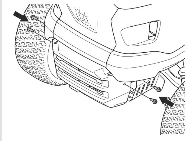
2. Installieren Sie den vorderen Stoßfänger und die 4 Schrauben.
