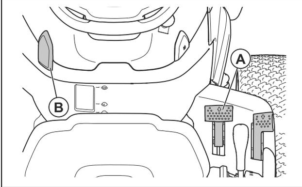
2. Ziehen Sie den Verriegelungshebel für die Geschwindigkeitsregelung (B) nach oben und halten Sie ihn so, während Sie das Vorwärtspedal loslassen.
