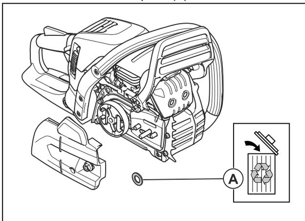
**Nota:** Si la cubierta del embrague es difícil de quitar, apriete la tuerca de la espada, accione el freno de cadena y suéltelo. Se oirá un clic si se suelta correctamente.
