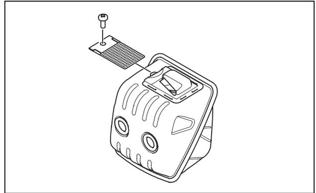
6. Instale el apagachispas. Sustituya el apagachispas si está dañado.
