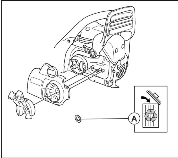
**Nota:** Si la cubierta del embrague es difícil de quitar, apriete la tuerca de la espada, accione el freno de cadena y suéltelo. Se oirá un clic si se suelta correctamente.
