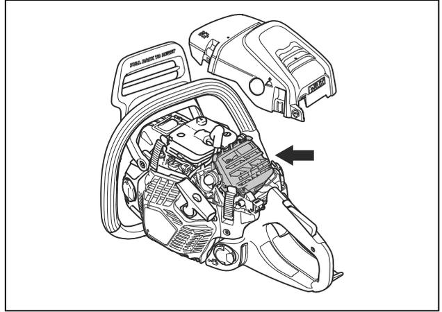
**Nota:** El producto puede usarse en condiciones de trabajo, climas o temporadas diferentes; por ello, existen distintos tipos de filtros de aire. Póngase en contacto con su distribuidor para obtener más información.
