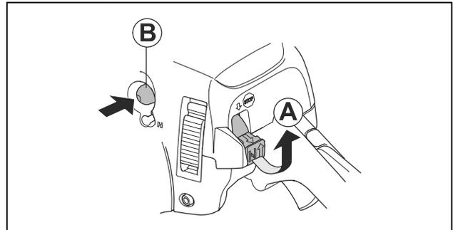
3. Presione la perilla de la bomba de combustible (B) 6 veces aproximadamente o hasta que la perilla se empiece a llenar de combustible. No es necesario llenar completamente la perilla de la bomba de combustible.
