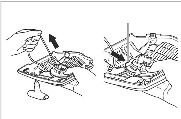
5. Retire el tornillo central, el disco de arrastre (A), el muelle del disco de arrastre (B) y la polea (C).
