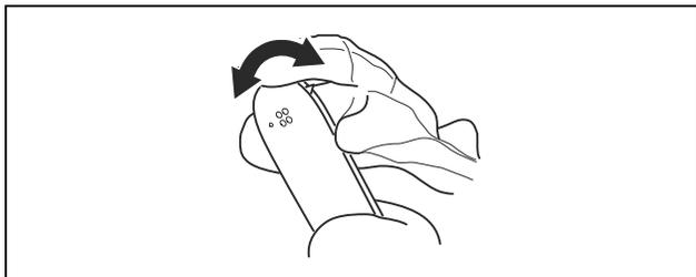
7. Drehen Sie die Führungsschiene täglich zur Verlängerung der Lebensdauer.
