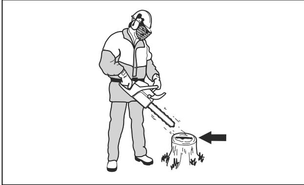
3. Wenn die Sägekettenschmierung nicht ordnungsgemäß funktioniert, führen Sie eine Prüfung der Führungsschiene durch. Anweisungen dazu finden Sie unter *So prüfen Sie die Führungsschiene auf Seite 115*. Wenden Sie sich an den Kundendienst, wenn Sie das Problem mit Hilfe der Wartungsschritte nicht beheben können.
