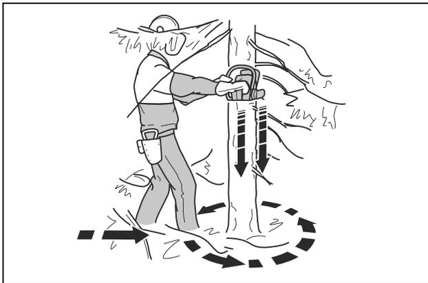
2. Entfernen Sie Unterholz aus dem Arbeitsbereich um den Baum. Entfernen Sie alle gesägten Teile aus dem Arbeitsbereich.
